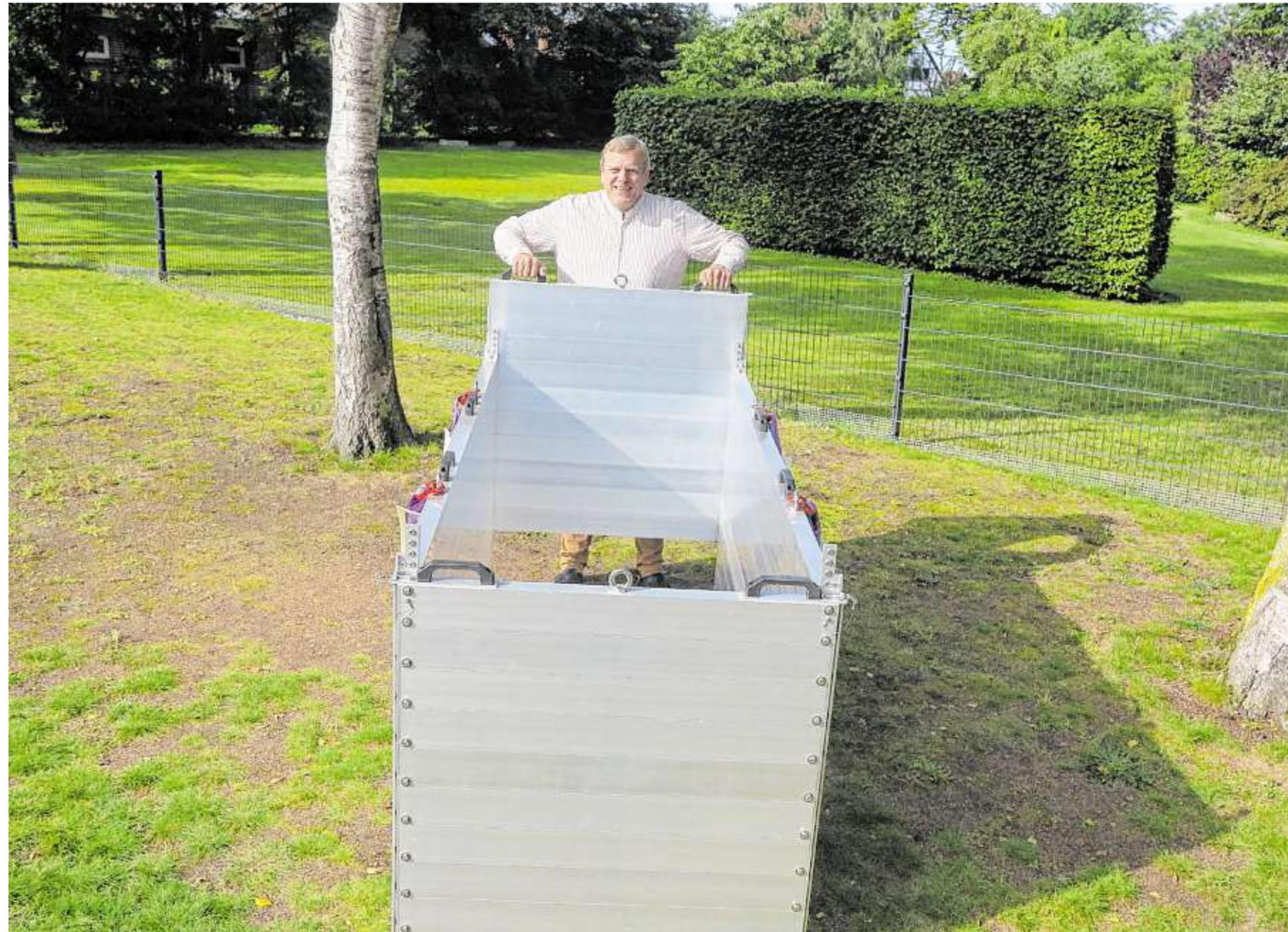
Rainer Bahrenburg zieht eine Wand seiner neuartigen Grabschalung heraus. Auf diese Konstruktion hat er ein Patent bekommen.
